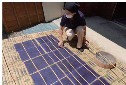
図8 「ツケル」作業、4枚12組の和紙を和紙を乾燥させる
