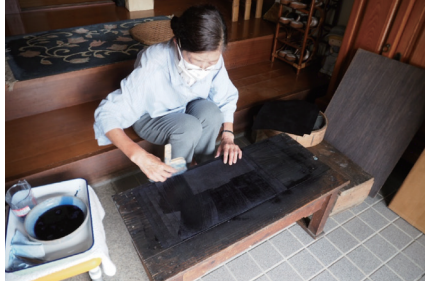
図9 「ネカス」作業、和紙を重ねながら、刷毛でシルをしみ込ませる
