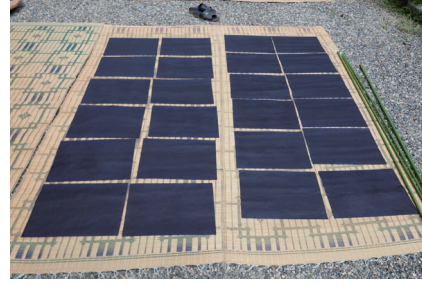
図10 「ツケル」作業、2枚24組の和紙を和紙を乾燥させる
