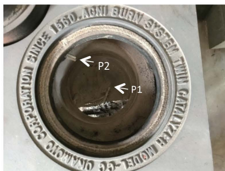
写真3 触媒前後のガス採取場所 注) 触媒を取り外しているときの写真。 P1：触媒前ガス採取場所 P2：触媒後ガス採取場所
