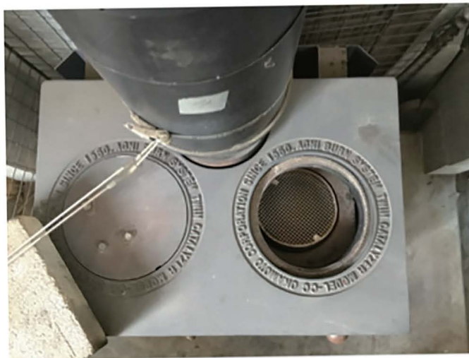
写真1 触媒の設置場所 注) この写真では、写真2の触媒を置いている。
