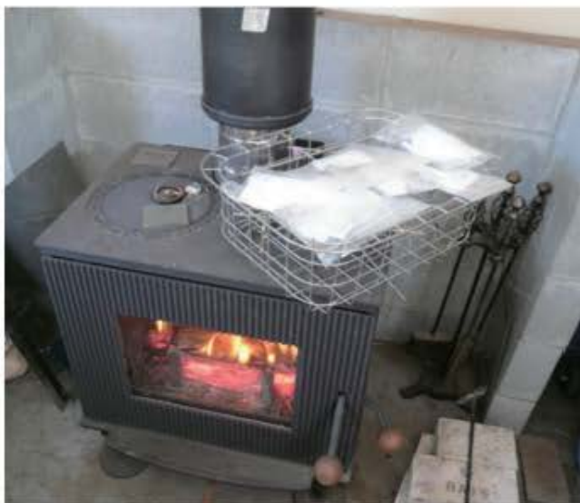
写真15. チャック付きプラスチック袋に入れ、触媒粘土の成形物の乾燥に薪ストーブ周辺を利用した。
