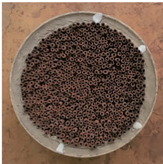
写真8 ハニカムに似た試作触媒 (HC' -2.2-HM )
