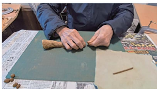
c. 右手の親指と人差し指でPTFE棒を固定し、左手でゆっくりと反時計方向に回しながら引き抜く。
