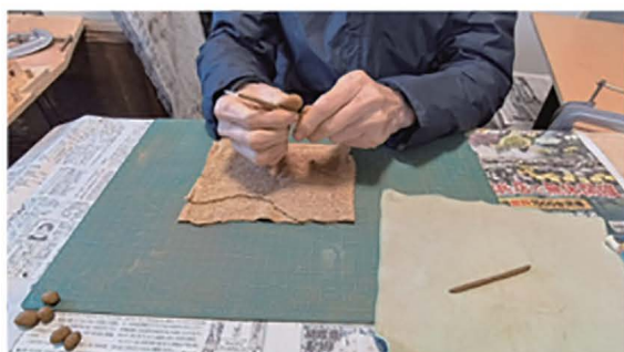
a. PTFE棒に触媒粘土を巻き付け、全体的に撚りをかけるようにねじっていく。
