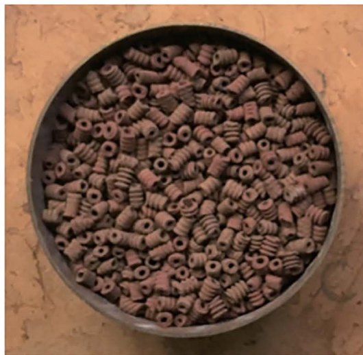
写真6 充填形試作触媒 (FL-2.9-8.9-HM)
