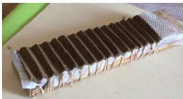
写真10. プラスチックフィルムとステンレスメッシュをV溝の上に置き、V溝に沿う形になるようタコ糸で縛り、その上から触媒粘土を押し込んだ。
