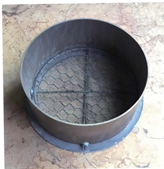
写真3 試験用触媒容器とドーナツ円形板 (下部)
