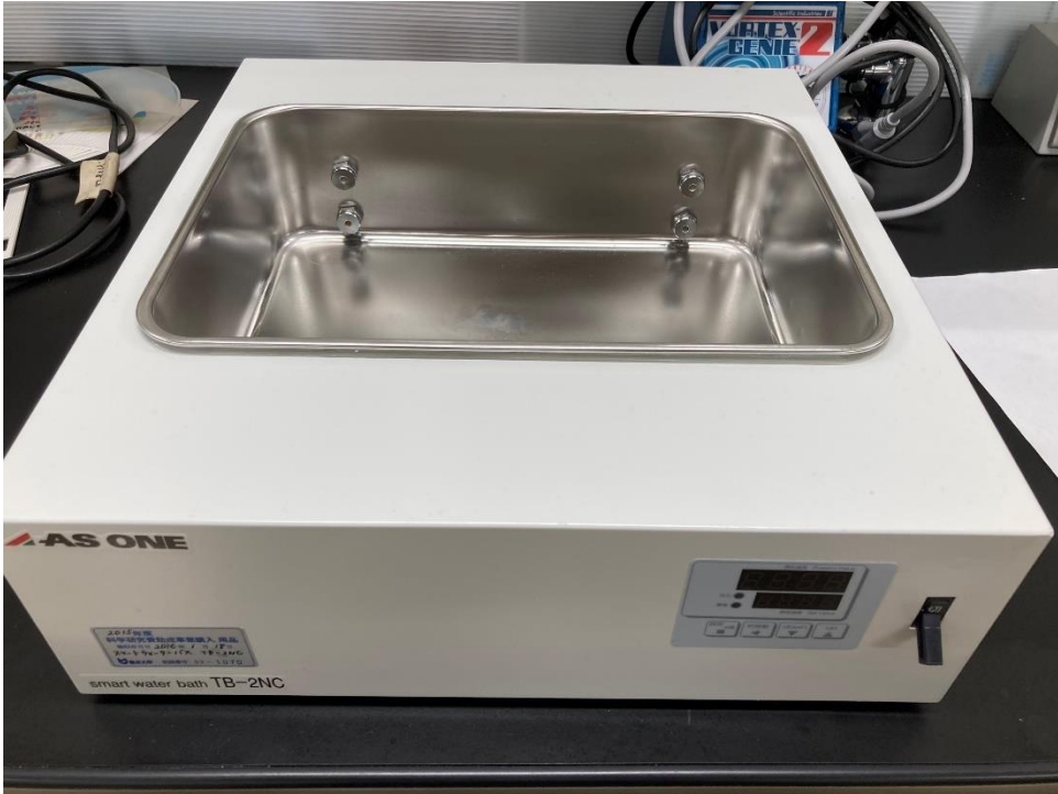
図 2-2 サンプルの保温に使用したウォーターバス
