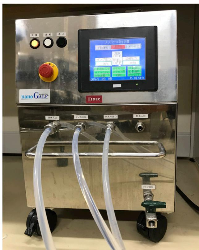
図 3. IDEC 社製の UFB 生成装置 (FZ1N-02 型) 本体部分
