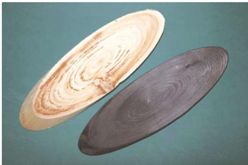
切り倒したヒノキ（スギ）を写真のように、斜めに、平行に約1cm厚さにカットして、表面を、エンドレスで磨き、表・裏面と側面を高温ハンドバーナーで、まんべんなく焼き目を入れる。成長層の柔らかい部分に少し焼き目のひび割れが入る程度まで、平均に焼くとよい。それ以上焼くと消し炭になってしまうので、工夫のしどころ。
