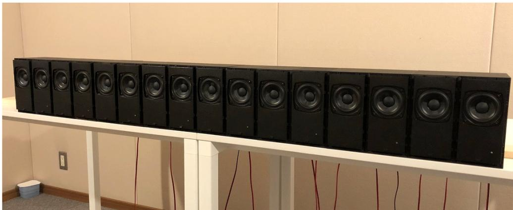
図 5.9: 作成した 16ch 直線スピーカアレー
