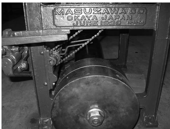
写真2 ブルサの絹織物・染織工場で使用されていた増澤商店の1928年6月付紡糸機械（部分）
