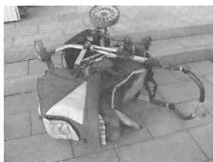
コンクリートへの95センチの落下
