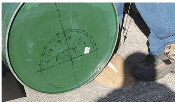
図4 焚き口となるペール缶の取り付け位置を決める。
