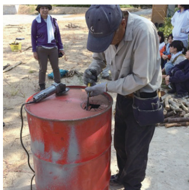
図7 煙突の取り付け位置を決めて広げているところ。
