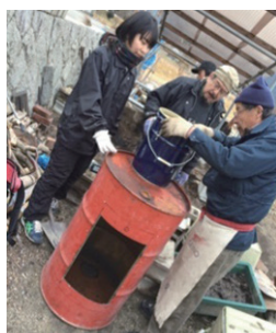
図3 200Lドラム缶の上部に炭の取り出し口をつける。
