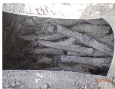
図20 焼き上がった炭：左が焚き口で右が煙突部分。焚き口の材は燃えて灰となっている。
