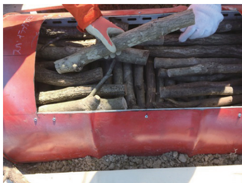
図17 ドラム缶窯に炭材となる薪を詰めているところ。長さを40cmにすることでドラム缶にきっちりと詰めることができる。
