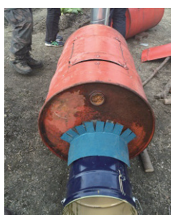
図10 ドラム缶に焚き口となるペール缶を取り付けたところ。つなぎ部分を覆うようにトタンでカバーしたところ。
