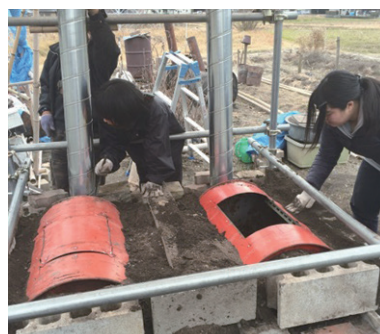
図13 新しい2基のドラム缶炭窯を設置しているところ。（2016年1月23日に交換した）
