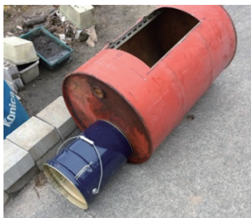
図4 焚き口となるペール缶の取り付け位置を決める。
