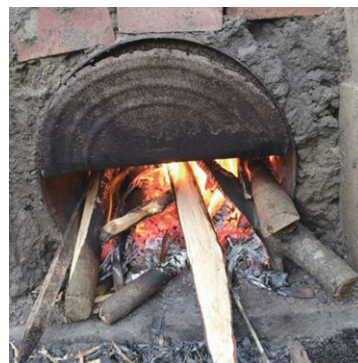
図18 焚き口から見たところ：細い焚き付けから火をつけて次第に太い枝に火をつける。
