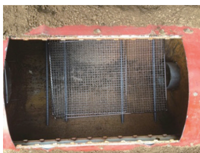
図9 ドラム缶内部：ロストルと呼ばれる鉄筋四本とその上にステンレスの網が2枚載っている。左が焚き口で、右下に煙突の口が見える。
