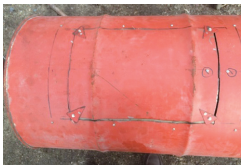
図3 200Lドラム缶の上部に炭の取り出し口をつける。
