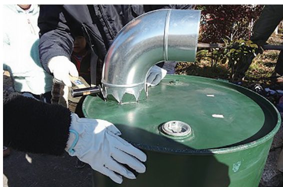
図8 L字型の煙突を取り付けたところ。
