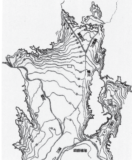
3 見えない水「地下水」の流れ 服部定治が、昭和32年、42年、57年の調査資料から作成
